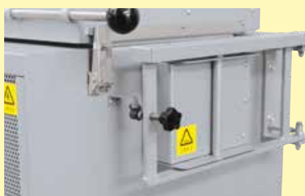
Odchylane drzwi równoległe po stronie czołowej
