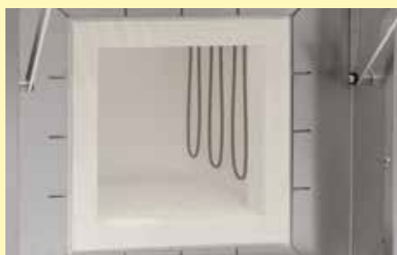
Komora pieca z wysokiej jakości materiału włóknistego i umieszczonych po obu stronach elementów grzewczych z dwukrzemku molibdenu
