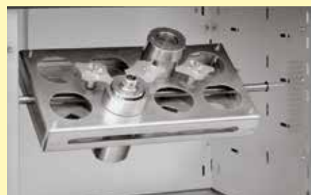
Elektryczny system obrotu (w tym przypadku z pomostem na zbiornik PARR dostosowanym do potrzeb klienta)
