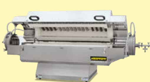
RSH 210/1000/11S z rurą roboczą ze szkła kwarcowego i zestawem zasilania gazowym 2
