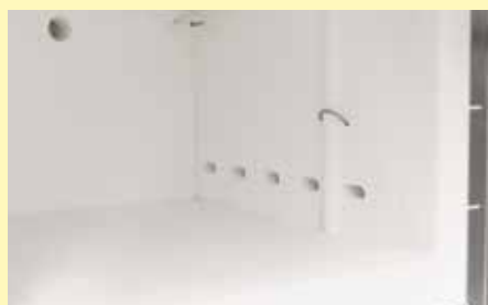
Wnętrze pieca z otworami wlotowymi powietrza do 6-krotnej wymiany powietrza na minutę
