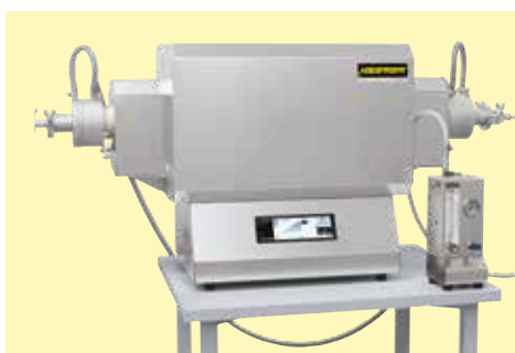
Piec rurowy RHTC 80/230/16 z zestawem do zasilania gazem osłonowym 2
