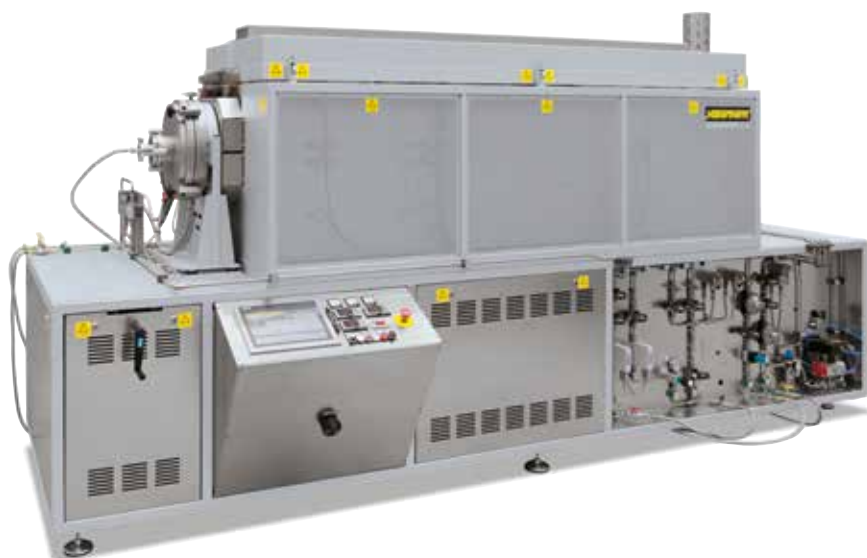
RSH 320/2000/09 H 2 z regulacją w 3 strefach do obróbki cieplnej metali szlachetnych
