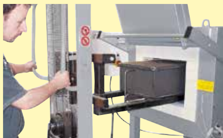
Załadunek skrzyni do wyżarzania w atmosferze gazu ochronnego za pomocą wózka załadunkowego
