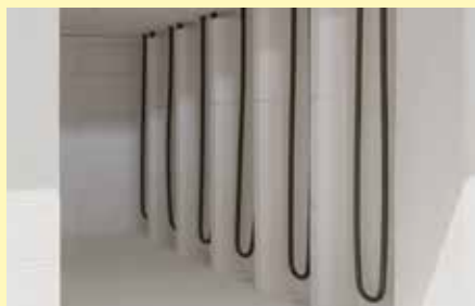
Zabezpieczenie elementów grzewczych przed uszkodzeniami mechanicznymi podczas załadunku i rozładunku jako wyposażenie dodatkowe
