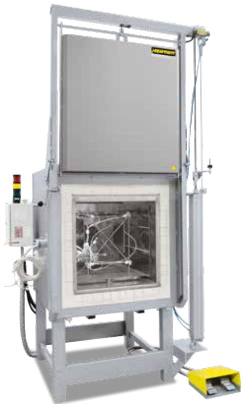
Stojak pomiarowy do wyznaczenia równomierności temperatury
