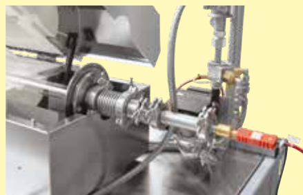
Gazoszczelne złącze obrotowe z chłodnicą gazu i termometrem do pomiaru temperatury wsadu
