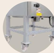
符合人体工学原理的装料架，用于炉前的装卸料
