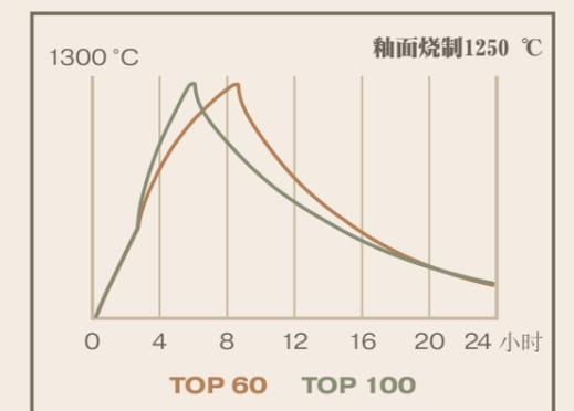
瓷胚烧制950 °C，釉面烧制1250 °C。包括窑具在内的装载重量：Top 60 - 18公斤，Top 100 - 30公斤。经过计算，能源价格：0.517元/kWh。（民用电第一梯度平均电费）
