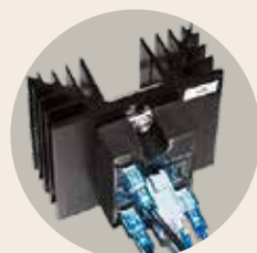
Geräuscharme Schaltung der Heizung über Halbleiterrelais
