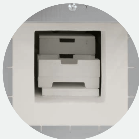
Załadunek w piecu wysokotemperaturowym LHTCT 03/16
