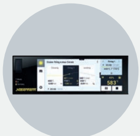
Sterownik z funkcją obsługi dotykowej do dowolnego programowania programów wypalania i prasowania/wytłaczania popularnych ceramik do licowania
