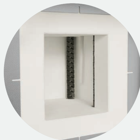
Komora pieca z umieszczonymi po obu stronach prętami grzewczymi SiC
