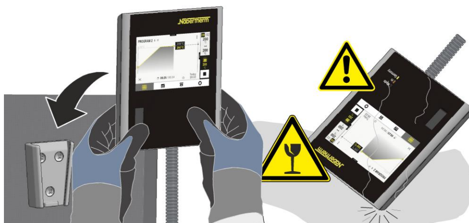
Fig. 30: Colocar o controlador no suporte que se encontra no forno (semelhante à figura)
