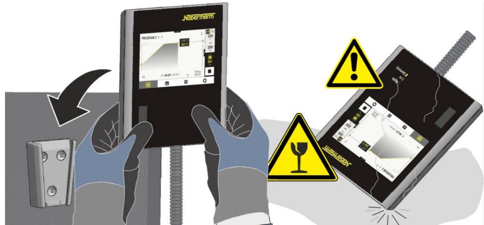
Fig. 18: Colocar o controlador no suporte que se encontra no forno (semelhante à figura)
