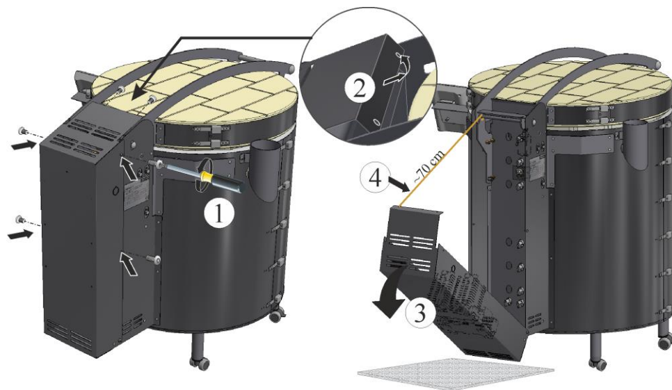
Fig. 46: Desmontar a cobertura da unidade de comando na parte de trás do forno (semelhante à figura)
