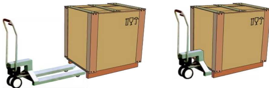
Fig. 7: O porta-paletes é inserido por completo por baixo da armação de transporte
