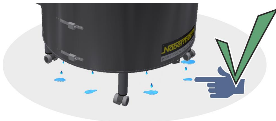
Fig. 26: Acumulações de condensado durante a primeira cozedura (semelhante à figura)
