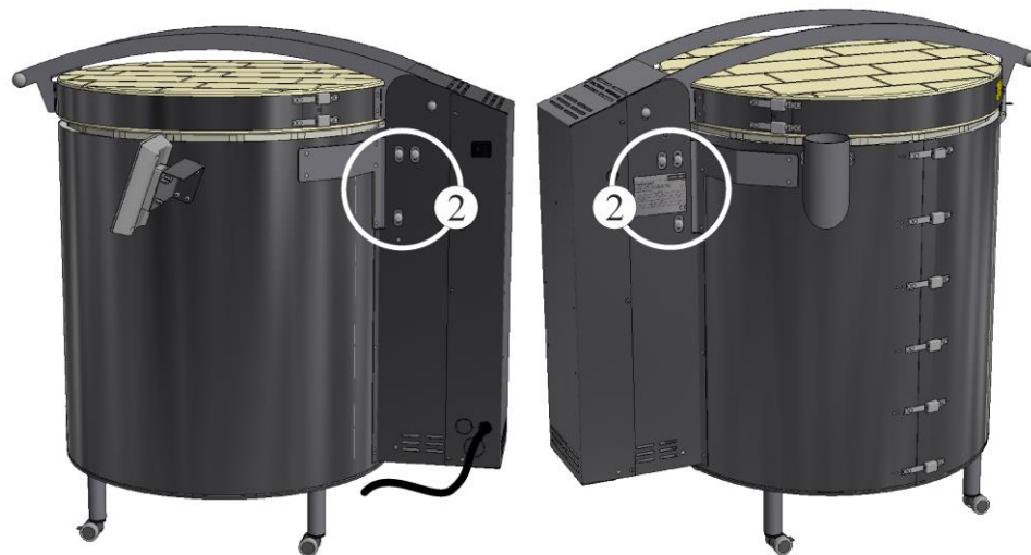
Fig. 40: Parafusos para ajustar a tampa (semelhante à figura)
