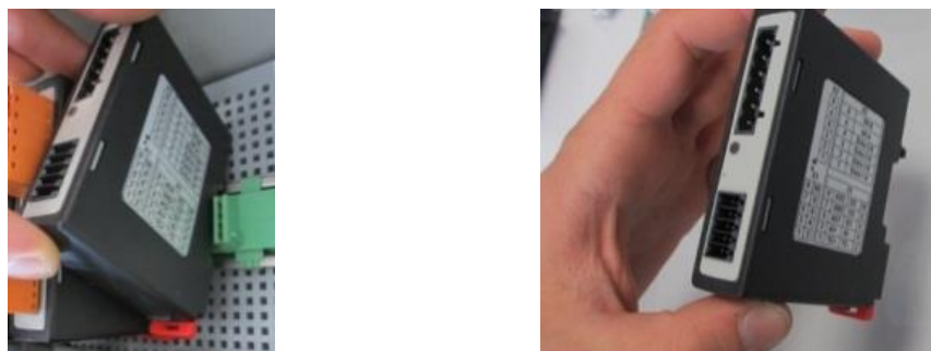
Obr. 10: Demontáž modulů regulátoru – část 2 (přibližný obrázek)
