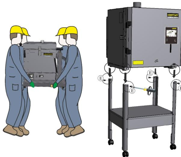
Avec l'aide d'au moins deux personnes, placez le four avec précaution sur le châssis-support et vérifiez qu'il est bien en place. Ensuite, le four est vissé sur le châssis-support aux positions (E).
