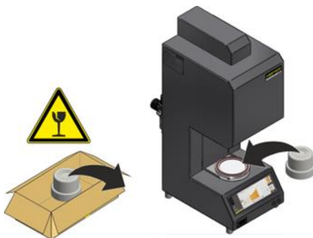
Sl. 15: postavljanje izolacije na podizni stol (slično kao na slici)
