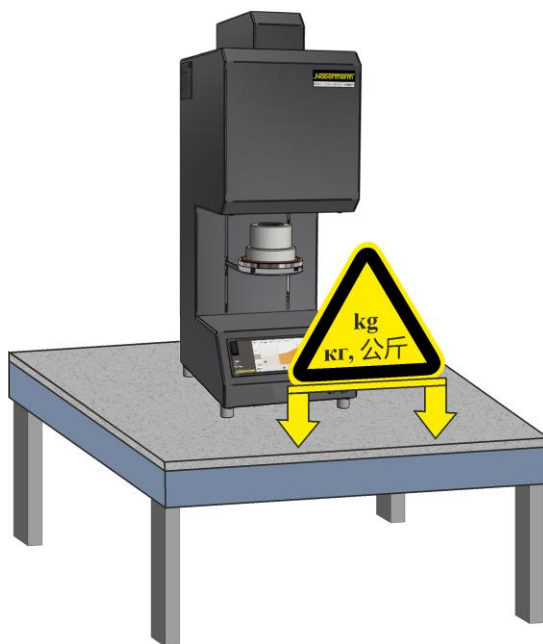
Fig. 8: Kontrollér bordets bæreevne (bordmodel) (eksempelbillede)
