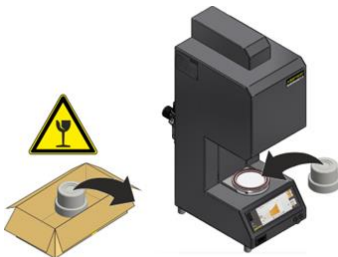
Fig. 15: Lægge isoleringen på løftebordet (eksempelbillede)
