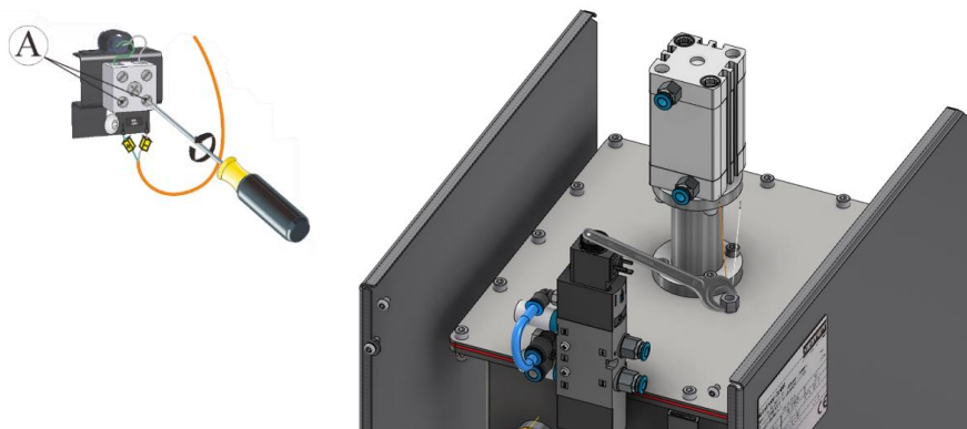
Slika 42: Demontaža termoelementa (podobno kot na sliki)
