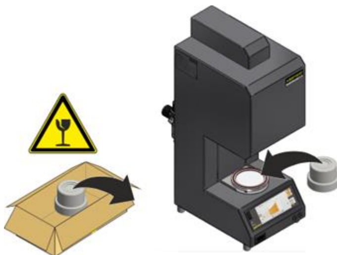
Slika 15: Odlaganje izolacije na dvižno mizo (podobno kot na sliki)
