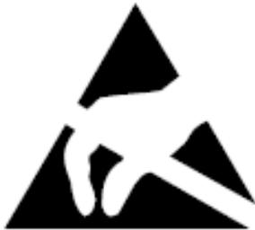
Quando enviar para manutenção Equipamento, Placas ou Componentes, deve ser observada a regulamentação EN 100 015 “Proteção para componentes sensíveis a cargas eletrostáticas”. Use somente embalagens ESD apropriadas para o transporte.
