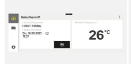
出现窑炉状态。几秒钟 后将显示温度。首次开 机时,会出现一个向 导,以引导输入基本设 置,例如语言。如果在 控制器上显示温度,则 控制器已运行就绪。
