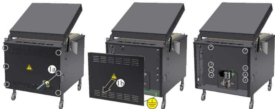
ภาพ 75: การถอดประกอบฝาครอบสวิตช์เกียร์จากด้านหลังของเตา (เหมือนกับภาพ) สำหรับการเปลี่ยนตัวให้ความร้อน จะต้องเปิดฝาด้านให้สุด (ดูที่บท “การเปิดและปิดฝาด้าน”)
