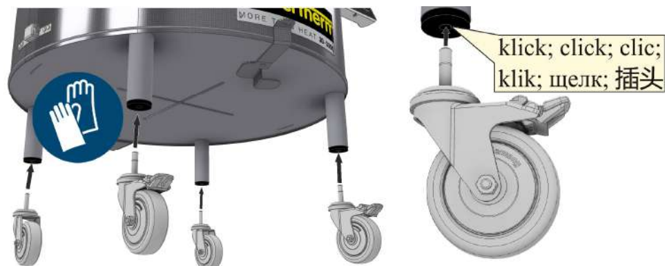
ภาพ 15: การประกอบล้อสำหรับการขนย้าย (เหมือนกับภาพ)
