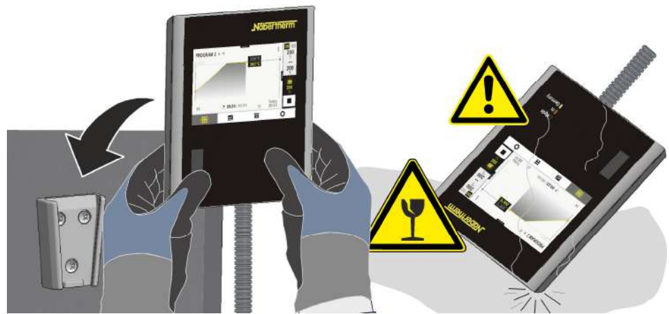
ภาพ 21: วางตัวควบคุมไว้ในที่ยึดบนเตา (เหมือนกับภาพ)
