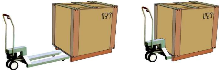
ภาพ 10: รถลากพาเลทถูกผลักไปใต้โครงสำหรับขนส่ง จนสุด
