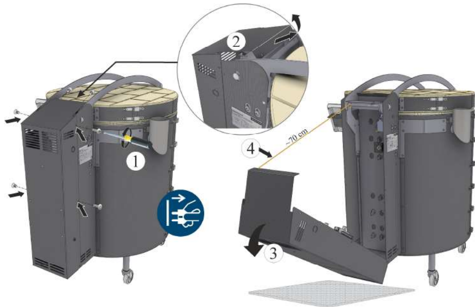
ภาพ 63: การถอดประกอบฝาครอบสวิทซ์เกียร์จากด้านหลังของเตา (เหมือนกับภาพ) สำหรับการเปลี่ยนตัวให้ความร้อน จะต้องเปิดฝาเตาให้สุด (ดูที่บท “การเปิดและปิดฝา”)
