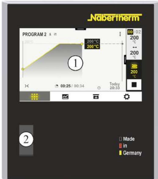
ภาพ 31: แผงควบคุม B500/C540/P570 (เหมือนกับภาพ)
