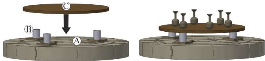
ภาพ 41: การวางชั้นวาง (C) ลงบนเสารองรับ (เหมือนกับภาพ)
