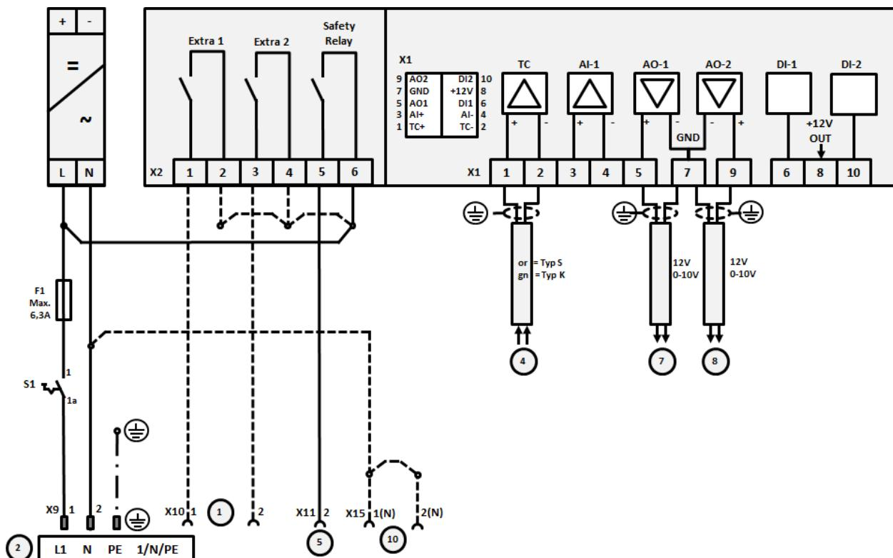
图示18：功率大于 3.6 kW 的窑炉连接，带2个加热回路
