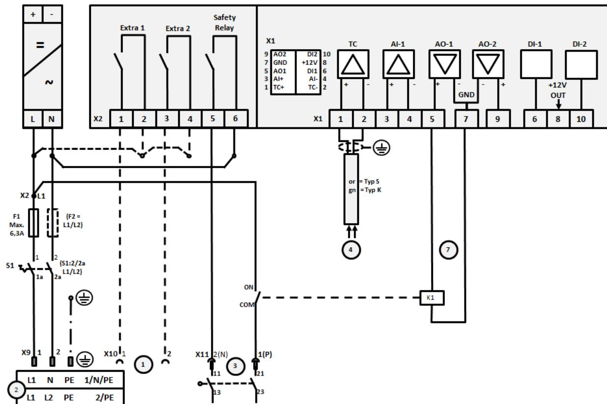
图示15：最大功率 3.6 kW的窑炉连接（截至2008年12月）
