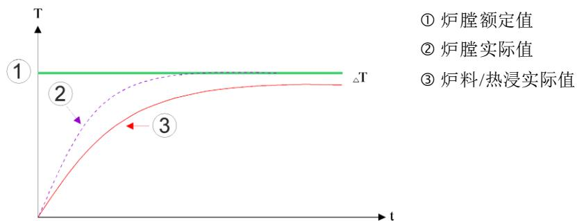
如在前面的段落中所说明的，炉料调节器对炉膛调节产生影响，以补偿在加热元件上的热电偶和炉料（比如在炉膛中央）上的热电偶之间的偏差。必须限制这一补偿，以免窑炉超调。
