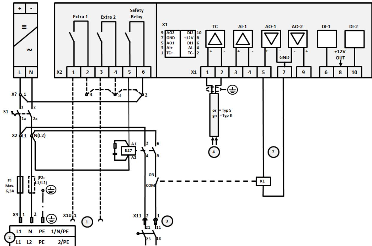
图示16：最大功率 3.6 kW 的窑炉连接（自2009年1月起）
