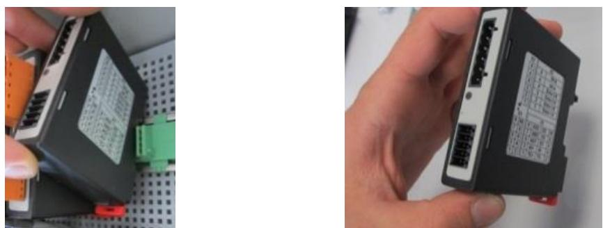
插图10： 调节器模块的拆卸—第 2 部分 (与插图类似)
