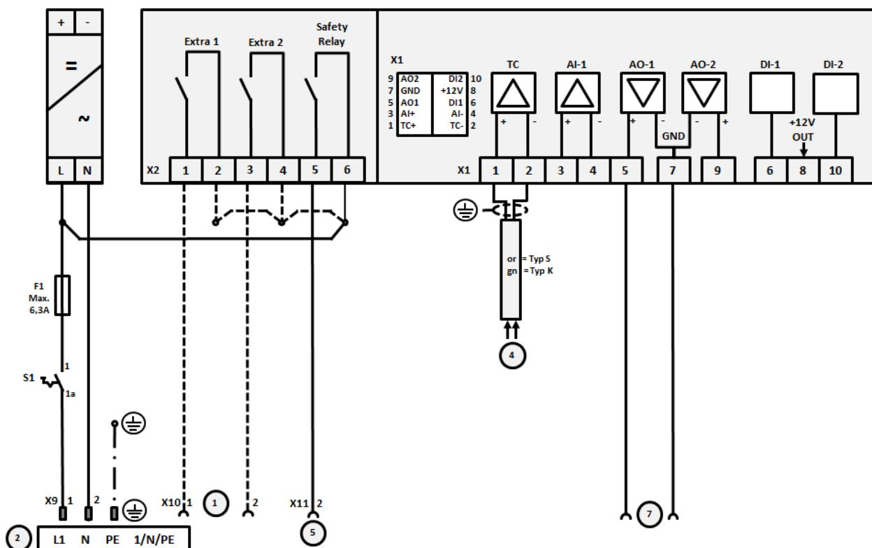
图示17：3.6 kW 以上的窑炉连接，单区
