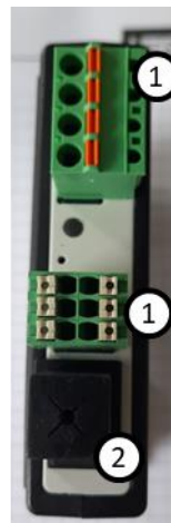
Abb. 12: Darstellung eines Reglermoduls NT-LTA
