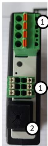
Рис. 12. Вид модуля регулятора NT-LTA
