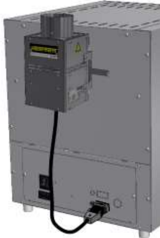
Afzuigshoorsteen met ventilator om ontstane afvoergassen beter uit de oven te kunnen leiden. Met controller B510 – P580 programma-afhankelijk schakelbaar (niet bij model L(T) 15..., L 1/12, LE 1/11, LE 2/11)*.
