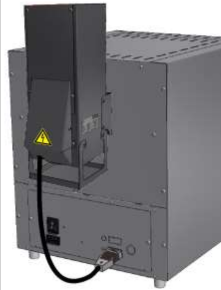
Katalysator voor de reiniging van organische bestanddelen uit de afvoerlucht. De organische bestanddelen worden bij ca. 600 °C katalytisch verbrand, d.w.z. opgesplitst in kooldioxide en waterdamp. Geuroverlast wordt op deze wijze grotendeels vermeden. Met de controllers B510 – P580 kan de katalysator programma-afhankelijk geschakeld worden (niet bij model L(T) 15..., L 1/12, LE 1/11, LE 2/11)*.
