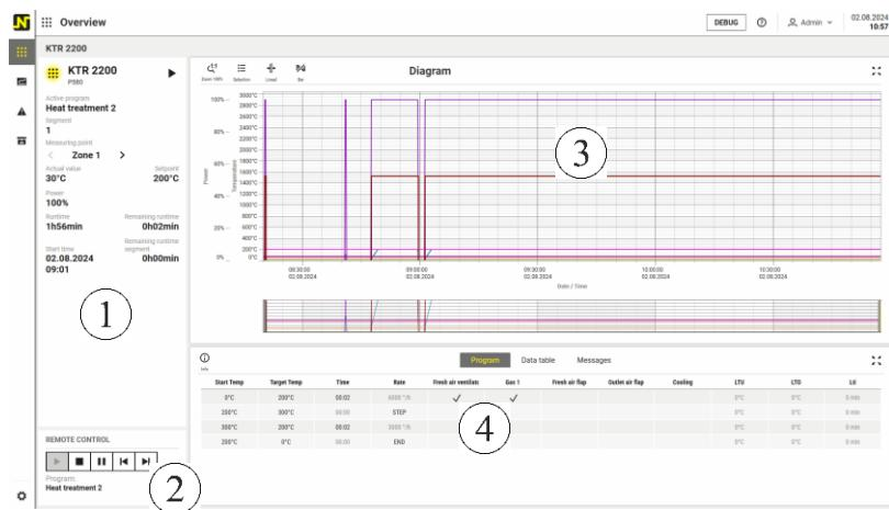
1 窑炉数据，2 远程控制（控制器控制），3 图表（曲线显示），4 当前数据表、程序和消息选项卡
