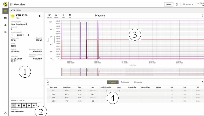
1 Ofendaten, 2 Fernsteuerung (Controllersteuerung), 3 Diagramm (Kurvenanzeige), 4 Reiter für die aktuelle Datentabelle, das Programm und Meldungen
