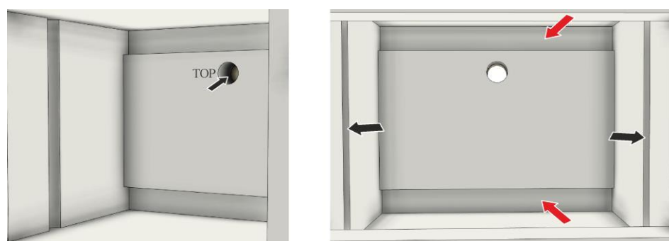
Fig.52 : Vue de l'intérieur du four pour la série de modèles L(T) 5/.. - L(T) 15/.. (figure similaire)
