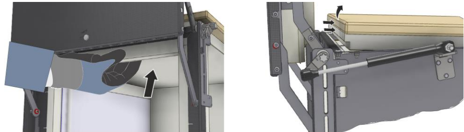
Fig.20 : Pousser avec précaution l'isolation de la voûte vers le haut ( LT 60/.. ) (figure similaire)
