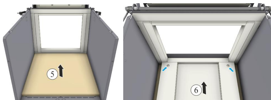
Fig.57 : Mise en place de la plaque thermo-isolante inférieure (figure similaire)
