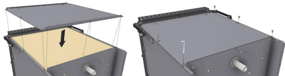
Fig.74 : Mise en place de la voûte (figure similaire)
