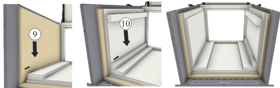
Fig.59 : Mise en place de la plaque thermo-isolante et de l'isolation latérales (figure similaire)
