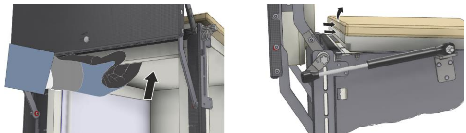
Fig.72 : Pousser avec précaution l'isolation de la voûte vers le haut (LT 60/..) (figure similaire)
