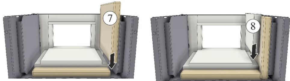
Abb. 39: Montage der seitlichen Dämmplatte und Isolierung (Abbildung ähnlich)
