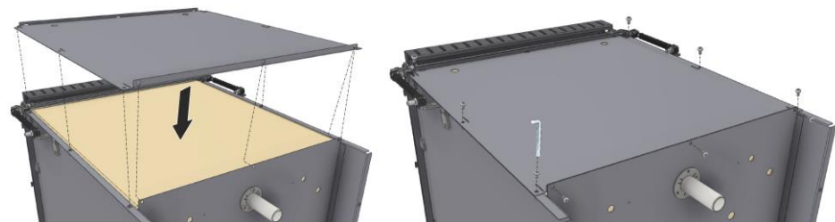
Abb. 74: Einbau der Decke (Abbildung ähnlich)
