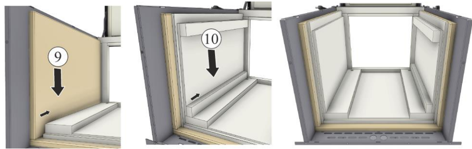
Abb. 59: Montage der seitlichen Dämmplatte und Isolierung (Abbildung ähnlich)
