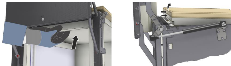
Abb. 20: Deckenisolierung vorsichtig nach oben drücken ( LT 60/.. ) (Abbildung ähnlich)
