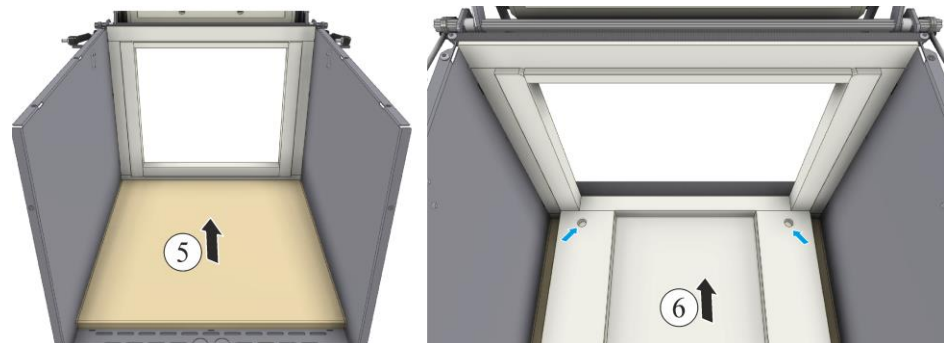
Abb. 57: Montage der unteren Dämm- und Isolierplatte (Abbildung ähnlich)
