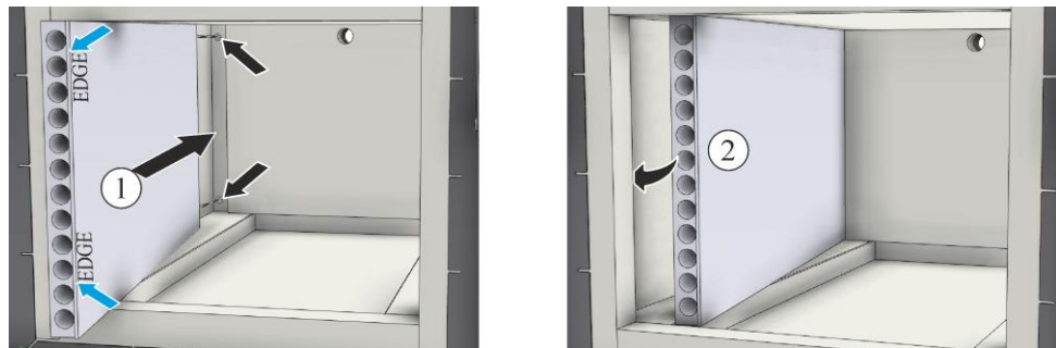
Abb. 70: Einbau der seitlichen Heizplatten (Abbildung ähnlich)
