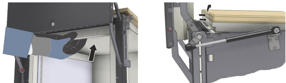
Fig. 72: Presionar cuidadosamente el aislamiento del techo hacia arriba (LT 60/..) (figura análoga)
