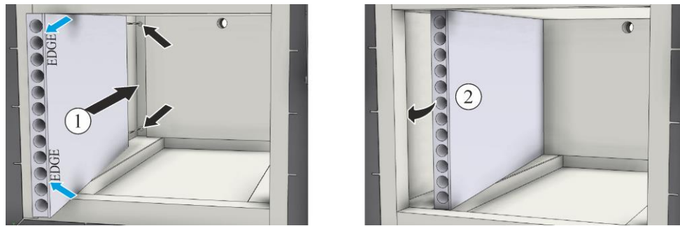
Fig. 70: Instalación de las placas calefactoras laterales (figura análoga)
