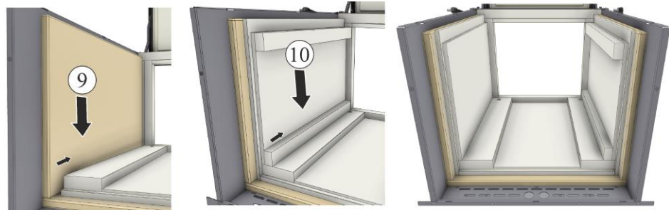
Fig. 59: Montaje del aislamiento y del panel aislante lateral (figura análoga)
