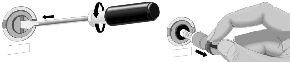
Fig. 44: Løsne og trekke ut sikringsholderen
