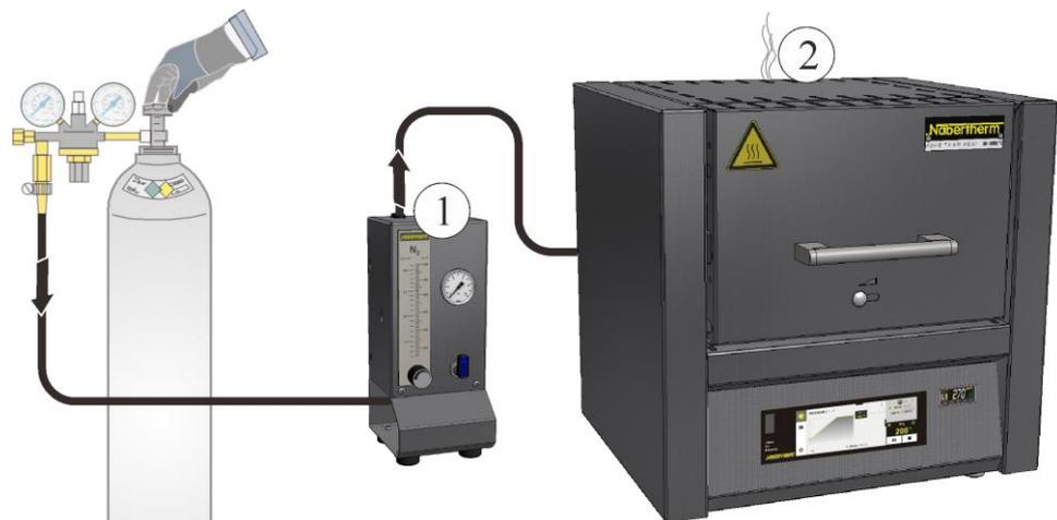
Fig. 51: Tilkobling på gassforsyningssystemet (illustrasjonen kan avvike)
