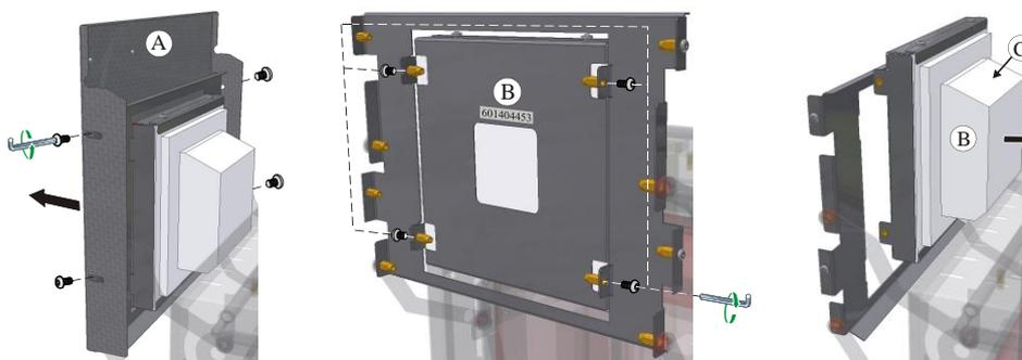
Fig. 49: Demontere dørkledningen/dørisolasjonen (illustrasjonen kan avvike)
