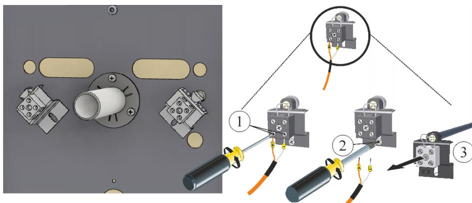
Fig. 48: Demontering av termoelementet/-elementene for ovnsrommet (illustrasjonen kan avvike)
