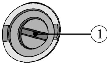
Fig. 43: Sikringen er plassert i enhetens bakvegg
