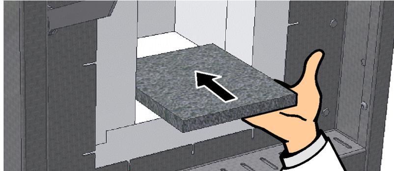
Fig. 26: Keramisk(e) innleggsplate(r) legges inn (inkludert i leveringsomfanget i samsvar med typen) (ligner på bildet)
