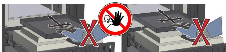
Fig. 37: Eksempel: Unngå skader på dørisolasjonen (illustrasjonen kan avvike)
