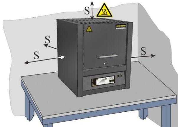
Fig. 18: Minste sikkerhetsavstand til brennbare materialer (bordmodell) (illustrasjonen kan avvike)
