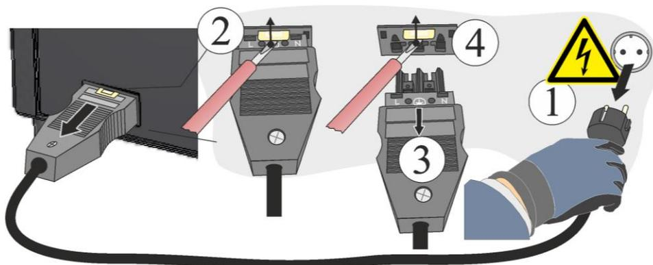
Fig. 47: Koble snap in-koblingen (plugg) fra ovnskapplingen (illustrasjonen kan avvike)
