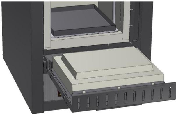
Bunnplater (av keramikk) og oppsamlingskar (tilgjengelig i keramikk eller stål avhengig av bruk) for å beskytte ovnen og for enkel charging.
