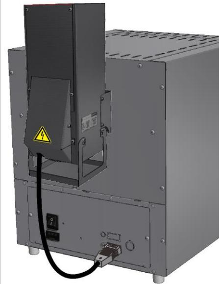
**Katalysator** for å rengjøre organiske bestanddeler fra avluften. Katalysatoren forbrenner de organiske bestanddelene ved 600 °C, dvs. at de spaltes opp i karbondioksid og vanddamp. Dette utelukker i stor grad vond lukt. Katalysatoren kan aktiveres med styringene B400 – P480 avhengig av program (ikke for modell L(T) 15..., L 1/12, LE 1/11, LE 2/11)\*.
