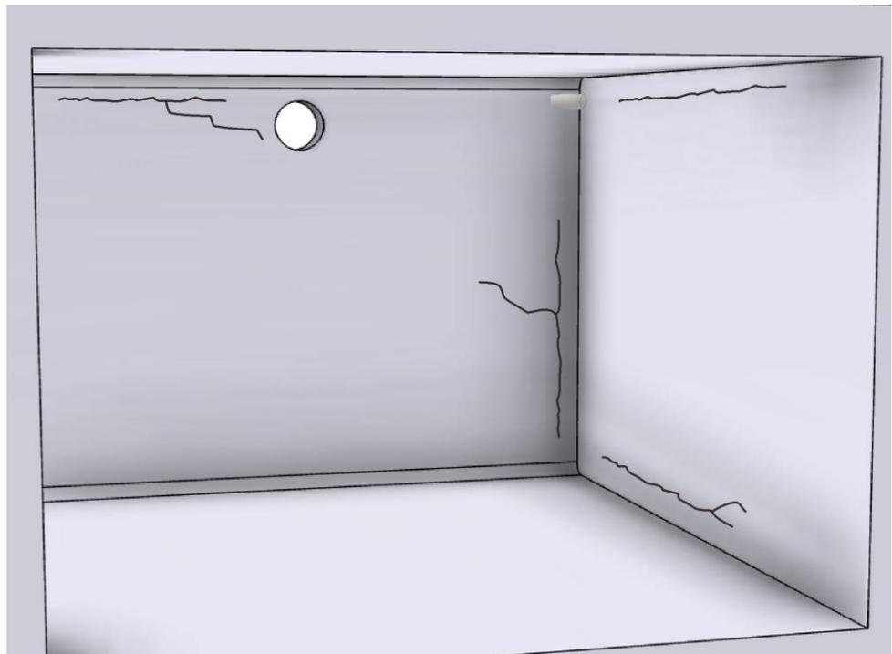
Fig. 34: Sprekkdannelse på innsiden av muffelen (illustrasjonen kan avvike)
