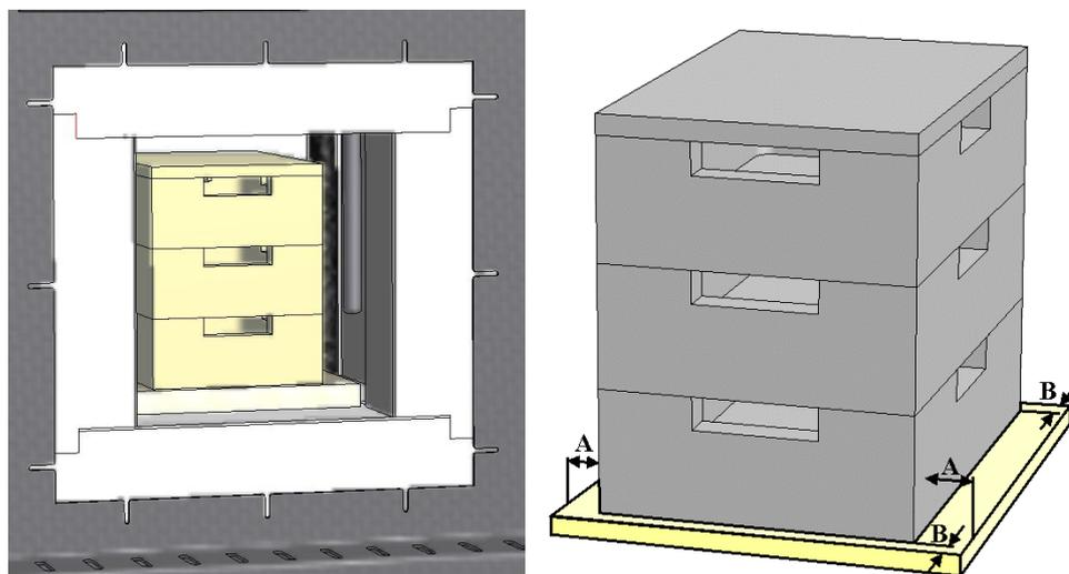
Fig. 41: Sikker charging til opptil tre nivåer (illustrasjonen kan avvike)
