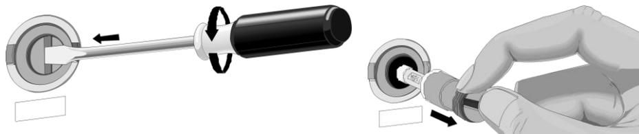
Abb. 42: Sicherungshalterung lösen und herausziehen
