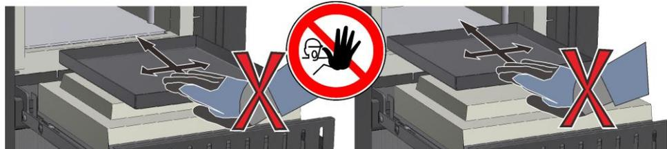
Abb. 34: Beispiel: Beschädigung der Türisolierung vermeiden (Abbildung ähnlich)
