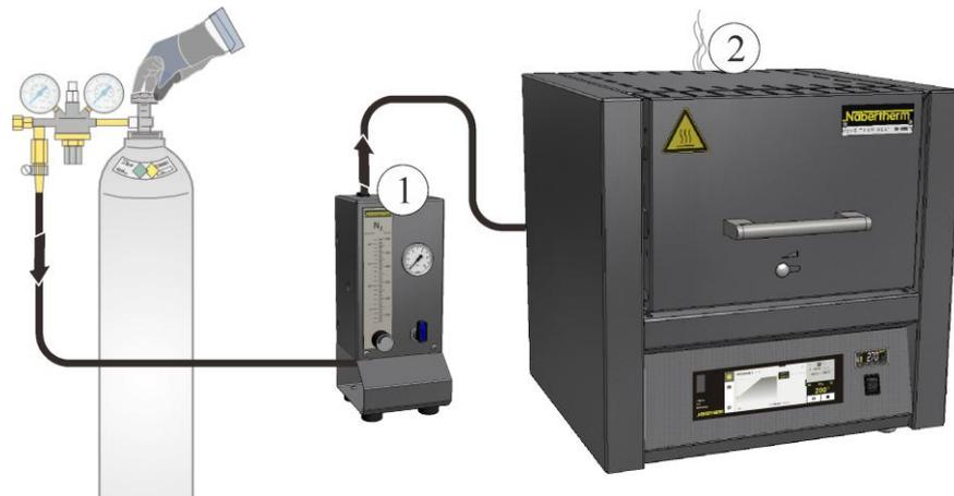
Abb. 37: Anschluss an das Begasungssystem (Abbildung ähnlich)
