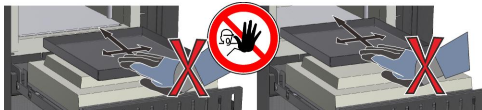
Εικ. 34: Παράδειγμα: Αποφυγή ζημίας της μόνωσης της θύρας (παρόμοια με την εικόνα)
