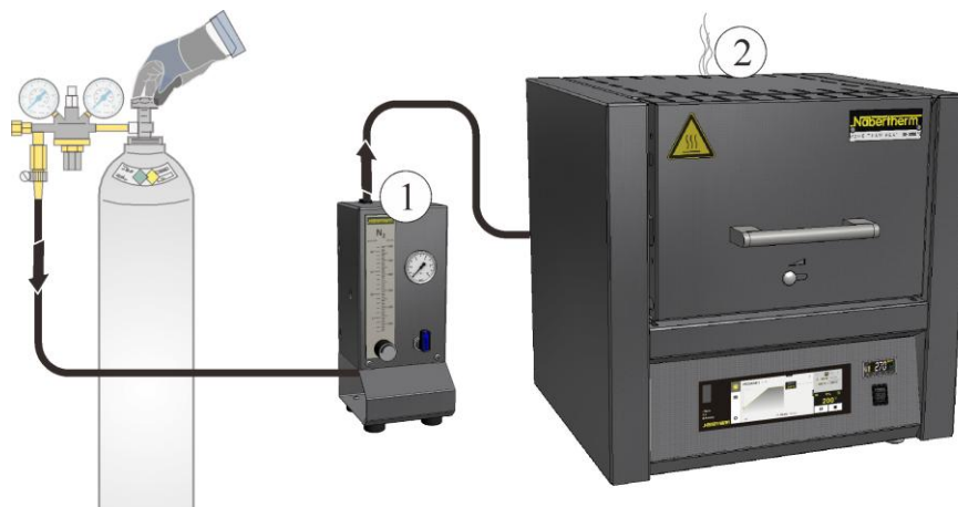
Εικ. 37: Σύνδεση στο σύστημα παροχής αερίου (παρόμοια με την εικόνα)
