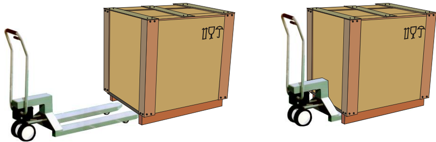
Εικ. 14: Το ανυψωτικό όχημα έχει τοποθετηθεί ολόκληρο κάτω από το πλαίσιο μεταφοράς
