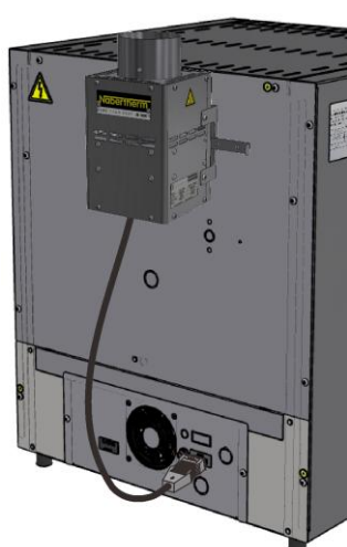
Elszívó kémény ventilátorral, hogy a keletkező füstgázokat jobban el lehessen vezetni a kemencéből. B510–P580 vezérlővel programtól függően kapcsolható*.
