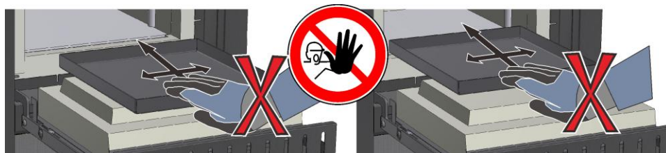
34. ábra: Példa: Az ajtószigetelés sérülésének elkerülése (az ábrához hasonlóan)
