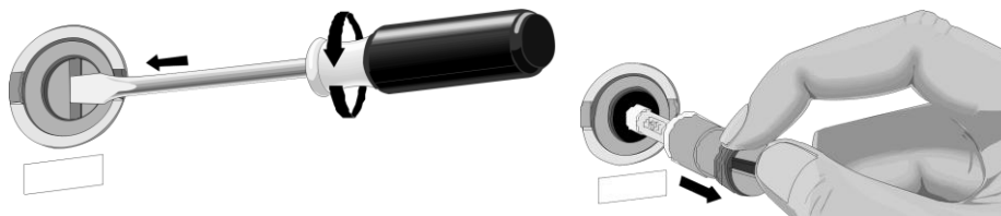
42. ábra: A biztosíték tartó kioldása és kihúzása
