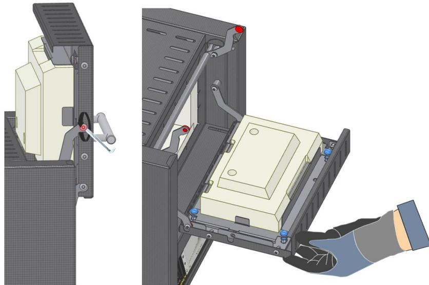
Fig. 47: Smontaggio della meccanica della porta
