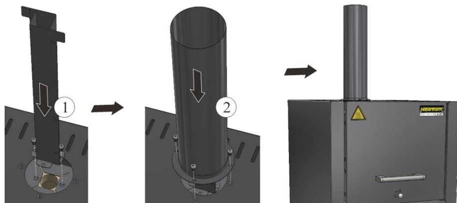
Fig. 21: Montaggio di un tubo del gas di scarico per i modelli LV(T) (illustrazione simile)
