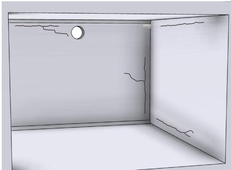
Fig. 32: Formazione di incrinature sul lato interno della muffola (illustrazione simile)
