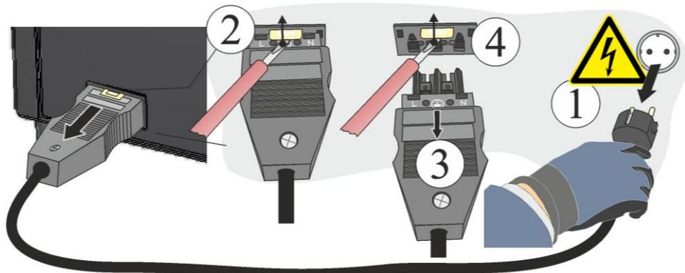
Fig. 45: Staccare il connettore snap-in (spina) dall'alloggiamento del forno (illustrazione simile)
