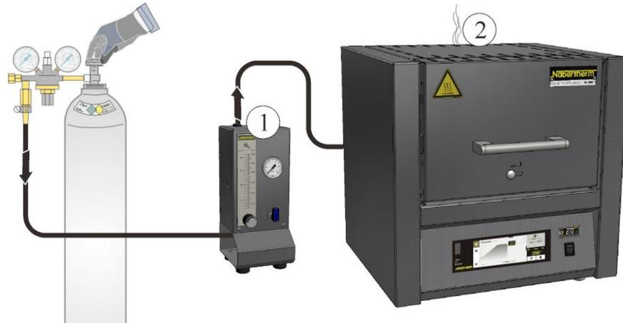
Fig. 37: Collegamento al sistema di gasaggio (illustrazione simile)
