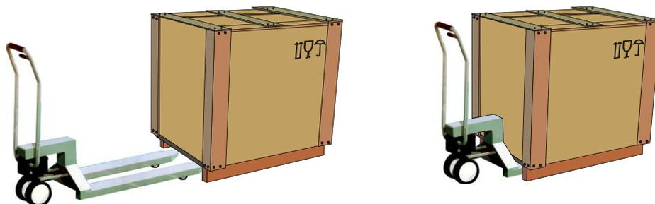
Fig. 14: Il carrello elevatore viene inserito **interamente** sotto il telaio di trasporto
