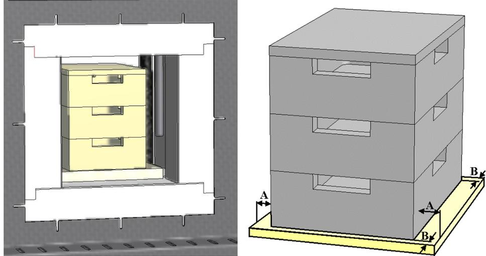
Fig. 40: Caricamento sicuro fino a un massimo di tre livelli (illustrazione simile)
