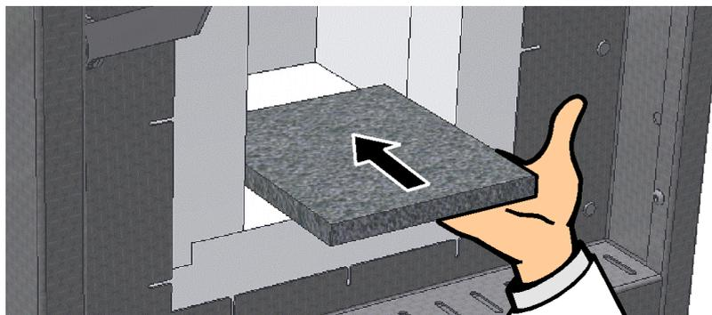
Fig. 23: Inserimento della piastra ceramica (contenuto nella fornitura secondo la versione/il modello) (illustrazione simile)
