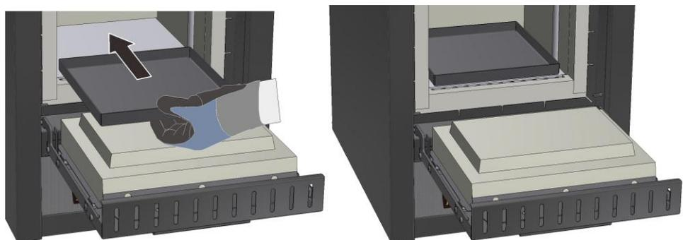
Fig. 33: Esempio: Posizionamento attento della vasca di raccolta (illustrazione simile)
