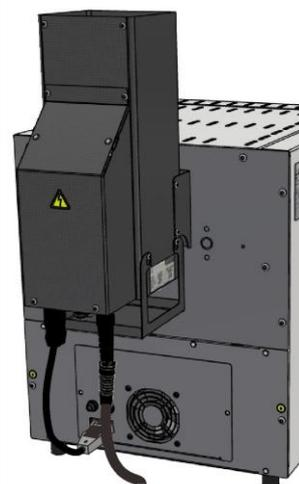
Catalizzatore per la pulizia dell'aria di scarico dai componenti organici. I componenti organici vengono sottoposti a combustione catalitica ad una temperatura di ca. 600 °C e vengono scissi in diossido di carbonio e vapore acqueo. Si esclude così ampiamente l'eventuale emissione di odori. Con i controller B510 - P580 è possibile attivare il catalizzatore in funzione del programma\* \*\*.
