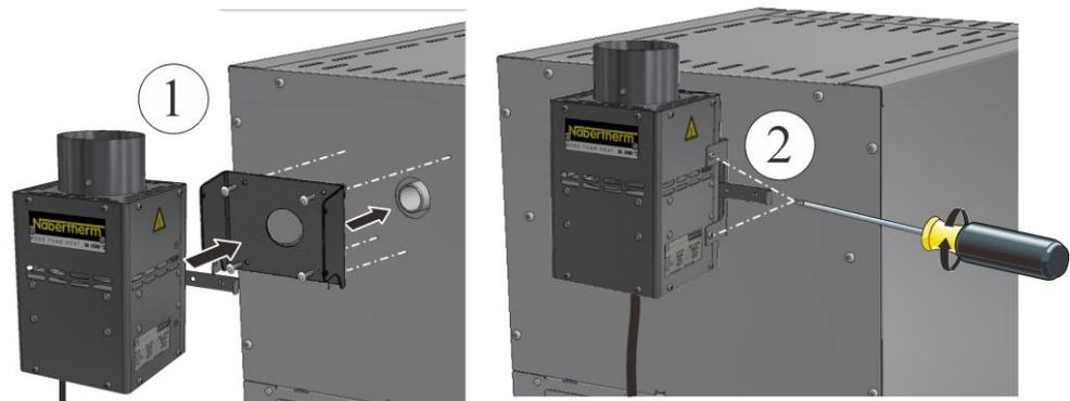
Fig. 19: Camino di scarico con ventilatore (illustrazione simile)
