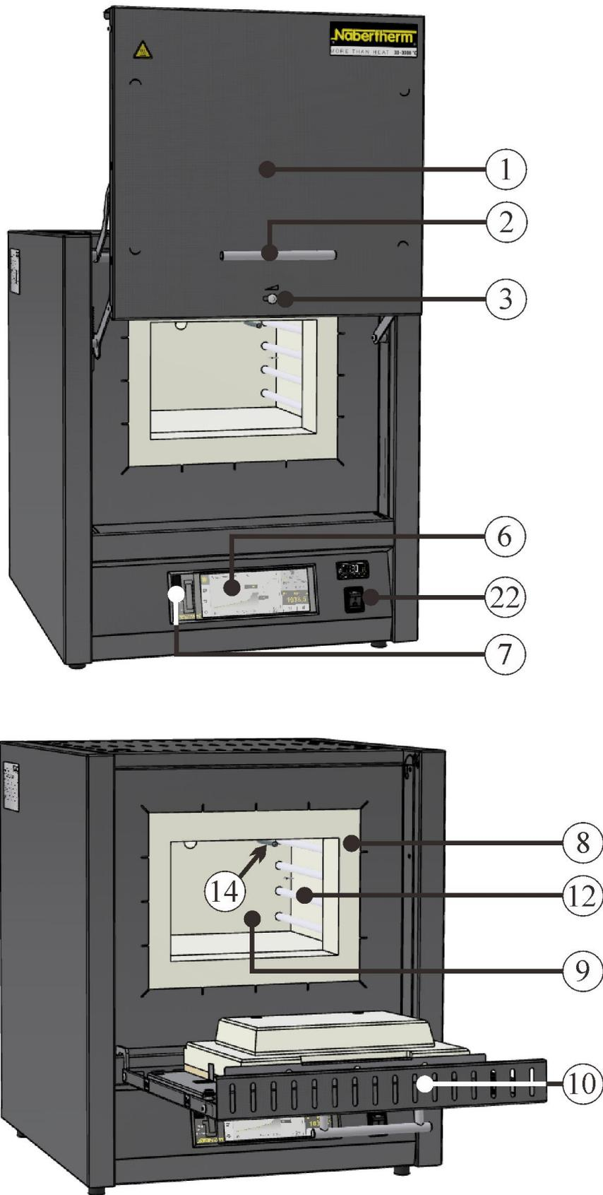
Fig. 2: Esempio: Panoramica generale modello porta ad apertura parallela LT ../13 e porta ribaltabile L../13 (illustrazione simile)
