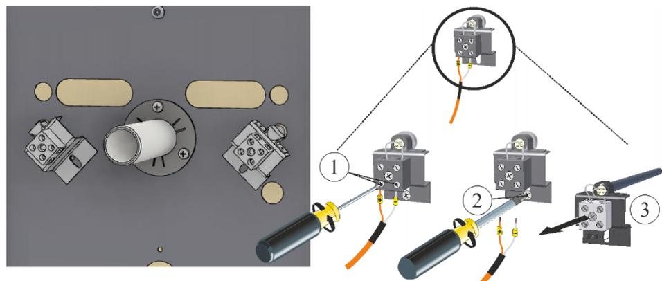
Fig. 46: Smontaggio della/delle termocoppia/e per la camera del forno (illustrazione simile)
