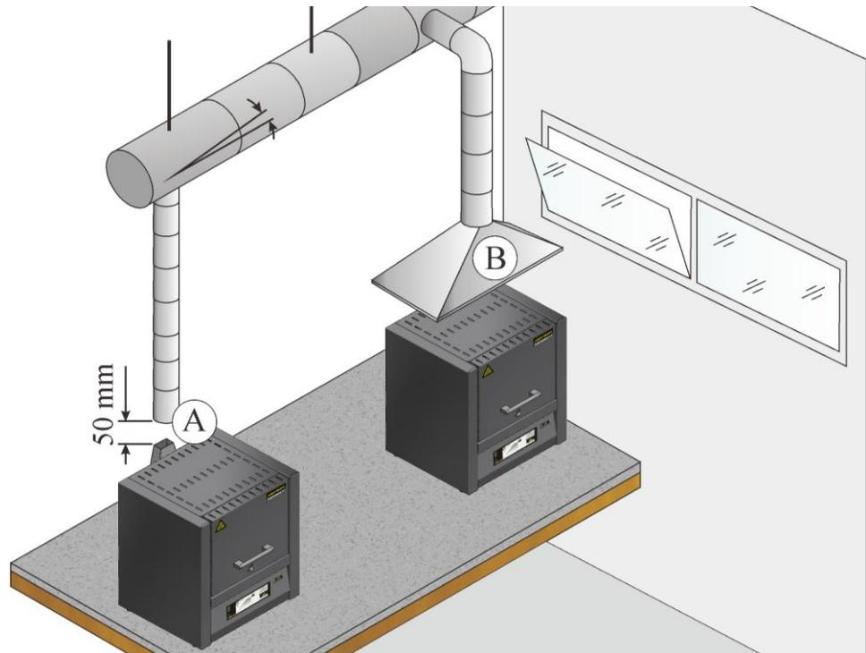
Fig. 22: Esempio: possibilità di deviazione per lo scarico dell'aria
