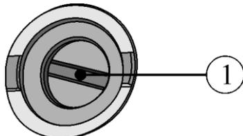
Fig. 41: Il fusibile si trova sulla parete posteriore dell'apparecchio
