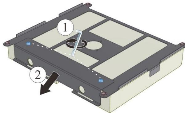
Fig. 48: Rimozione dell'isolamento della porta (illustrazione simile)
