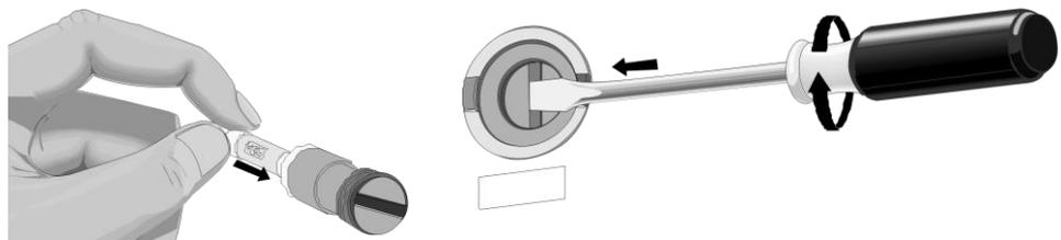
Fig. 44: Inserire il fusibile
