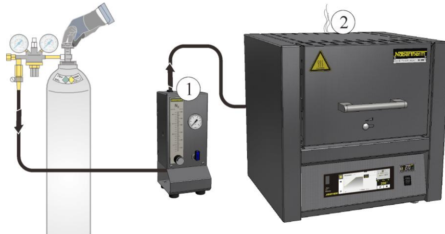
Bild 37: Anslutning till gasningssystemet (liknar den på bilden)
