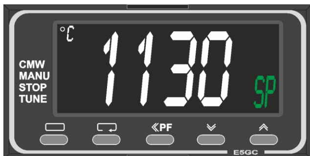
Fig. 4 : Régulateur de sécurité de surchauffe avec réinitialisation manuelle (figure similaire)
