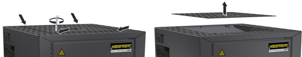
Fig. 50 : Démonter le couvercle (figure similaire)
