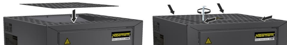
Fig. 46 : Montage du couvercle (figure similaire)
