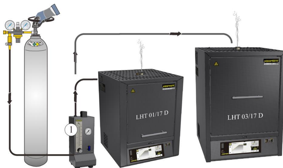
Fig. 58 : Raccordement au système d'alimentation en gaz (figure similaire)
