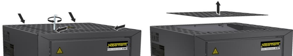
Fig. 35 : Démontez le couvercle (figure similaire)
