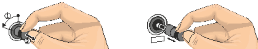
Fig. 54 : Détacher le support pour fusible et l'extraire (figure similaire)
