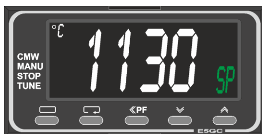
Fig. 33 : Régulateur de sécurité de surchauffe (figure similaire)
