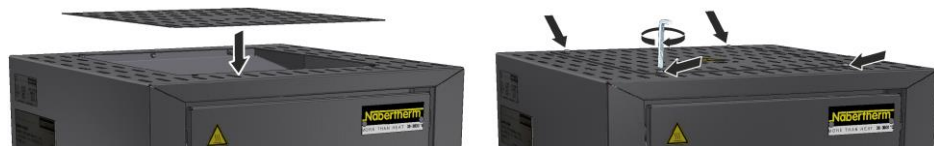
Fig. 37 : Montage du couvercle (figure similaire)
