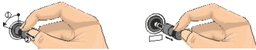
Εικ. 54: Ξεβιδώστε την υποδοχή της ασφάλειας και τραβήξτε προς τα έξω (παρόμοια με την εικόνα)
