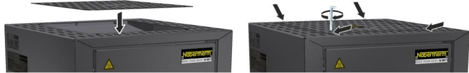
Εικ. 46: Εγκατάσταση του καλύμματος (παρόμοια με την εικόνα)
