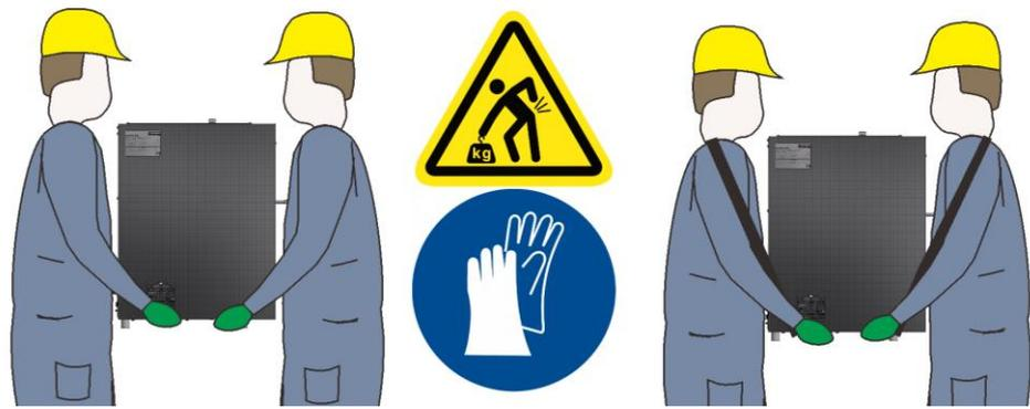
6. Mettere le mani lateralmente sotto il forno per trasportarlo e badare ad afferrarlo in modo sicuro.
