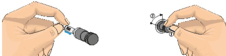
Fig. 56: Inserimento del portafusibili (illustrazione simile)
