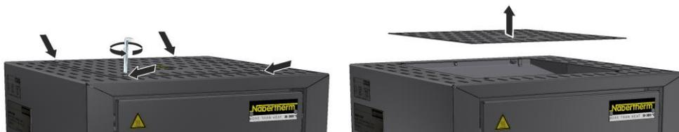
Fig. 17: Smontaggio della copertura (illustrazione simile)
