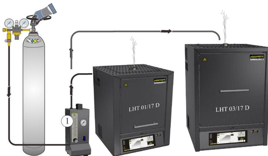
Fig. 58: Collegamento al sistema di gasaggio (illustrazione simile)
