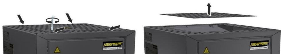
Fig. 35: Smontaggio della copertura (illustrazione simile)
