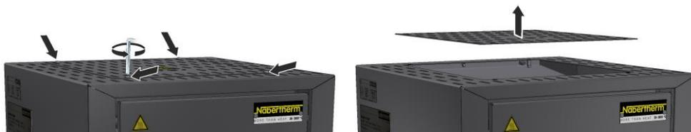
Fig. 50: Smontaggio della copertura (illustrazione simile)
