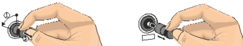
Fig. 54: Allentare e rimuovere il portafusibile (illustrazione simile)
