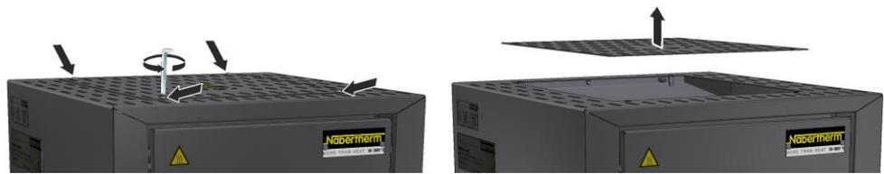
Fig. 40: Smontaggio della copertura (illustrazione simile)
