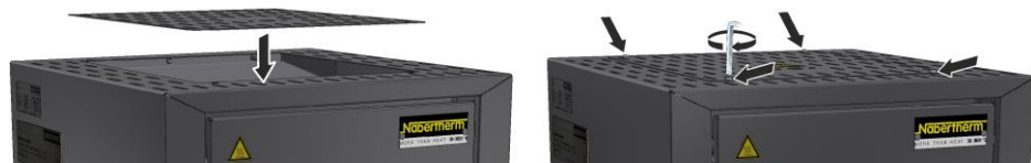
46 pav. Dangčio montavimas (panašu į paveikslėlio vaizdą)
