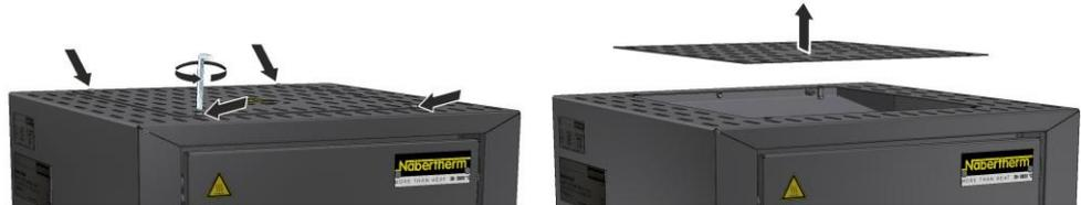
Fig. 50: Desmontaje de la cubierta (figura análoga)
