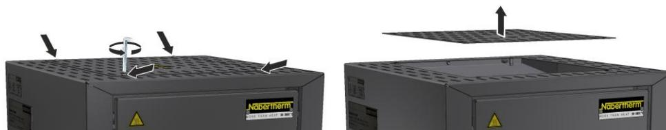
Fig. 40: Desmontaje de la cubierta (figura análoga)
