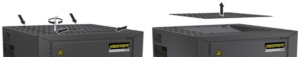
Fig. 17: Desmontaje de la cubierta (figura análoga)
