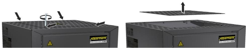
Fig. 35: Desmontaje de la cubierta (figura análoga)
