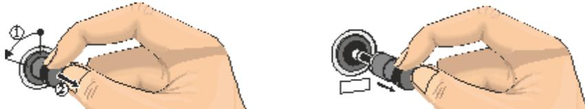
Fig. 54: Cómo soltar y extraer el portafusibles (figura análoga)
