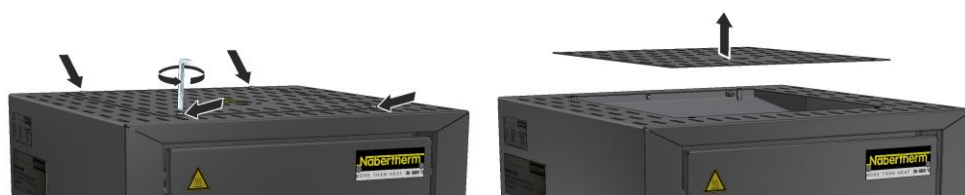
Bild 40: Demontering av lock (liknar det på bilden)
