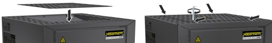
Bild 19: Montering av lock (liknar det på bilden)
