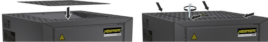
Bild 46: Montering av lock (liknar det på bilden)
