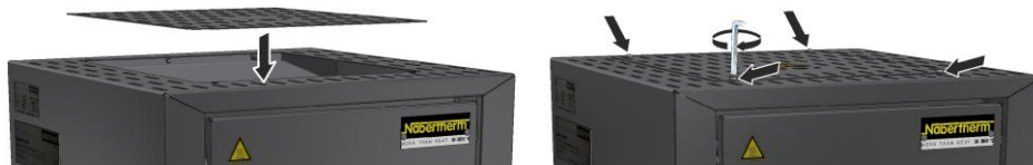
Bild 37: Montering av lock (liknar det på bilden)
