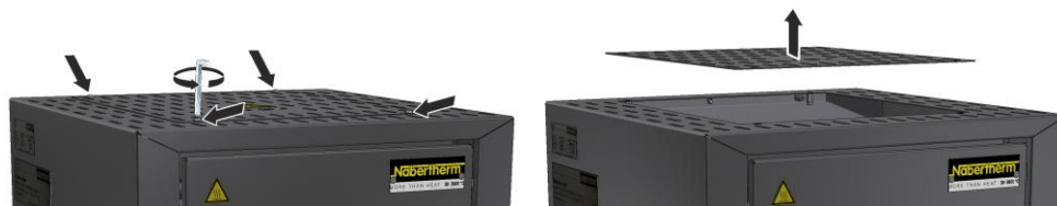
Bild 17: Demontering av lock (liknar det på bilden)
