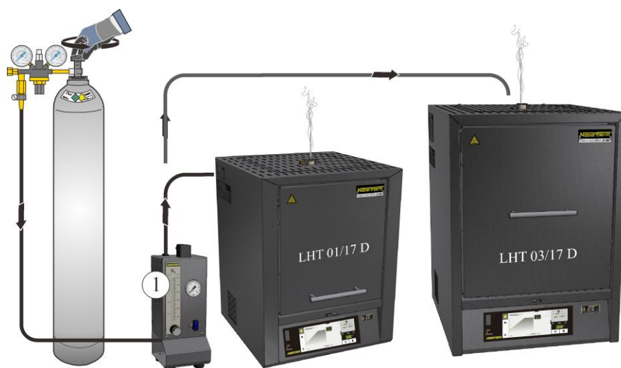
Bild 58: Anslutning till gasningssystem (liknar det på bilden)
