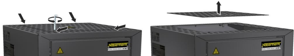
Kuva 15: Katteen purkaminen (kuva viitteellinen)
