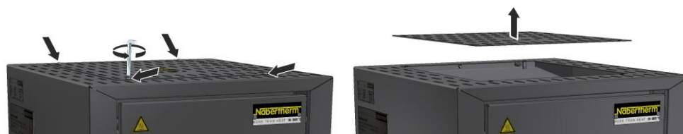
Kuva 31: Katteen purkaminen (kuva viitteellinen)
