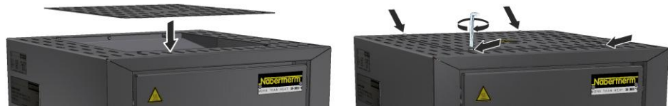
Kuva 42: Suojakatteen asennus (kuva viitteellinen)
