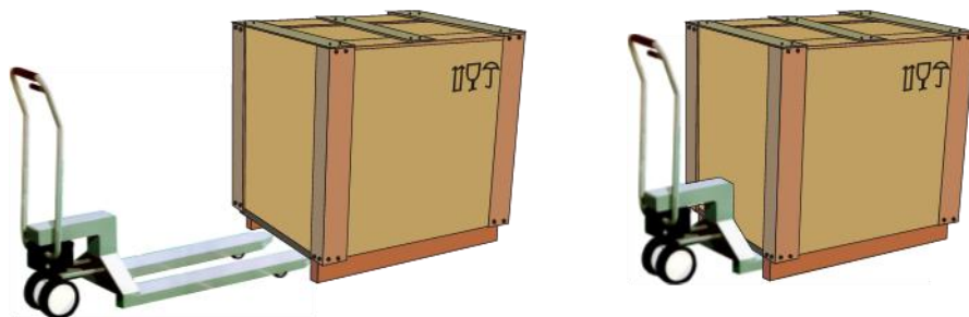
Kuva 10: Nostovaunu työnnetään täysin kuljetustelineen alle
