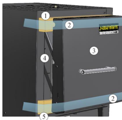
Kuva 11: Kuljetusvarmistuksen poistaminen (kuva viitteellinen)
