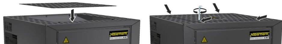
Kuva 17: Suojakatteen asennus (kuva viitteellinen)
