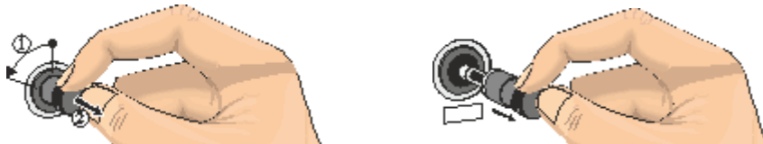
Kuva 54: Varokkeen pidikkeen irrottaminen ja ulosveto (kuva viitteellinen)
