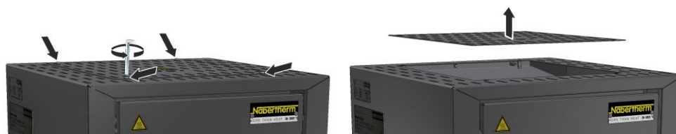
Kuva 36: Katteen purkaminen (kuva viitteellinen)
