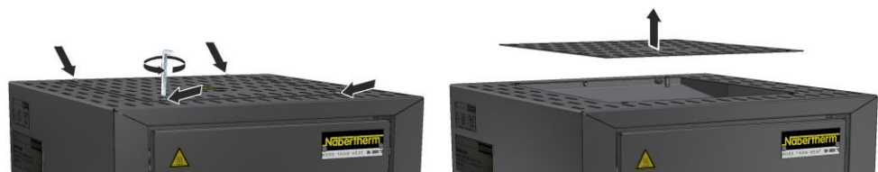
Kuva 46: Katteen purkaminen (kuva viitteellinen)
