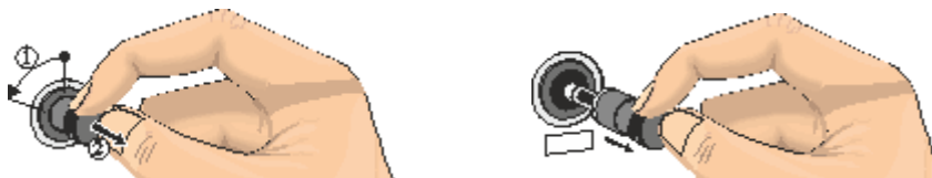
Fig. 53: Løsne og trekke ut sikringsholderen (illustrasjonen kan avvike)
