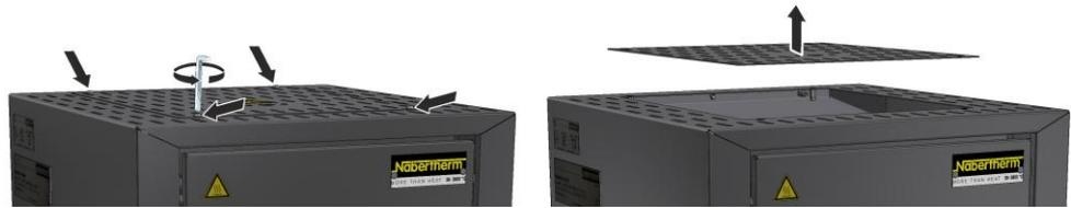
Fig. 15: Desmontar a cobertura (semelhante à figura)
