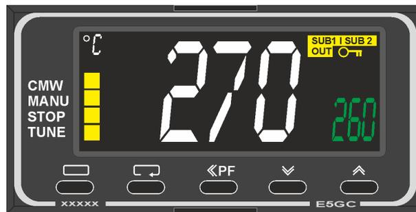
Fig. 60: Controlador de limite da temperatura OMRON E5GC (semelhante à figura)
