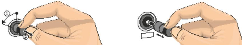
Fig. 54: Soltar e retirar o porta-fusível (semelhante à figura)
