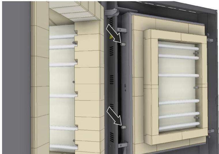
Exemple : Bornes de connexion des éléments chauffants de la porte
