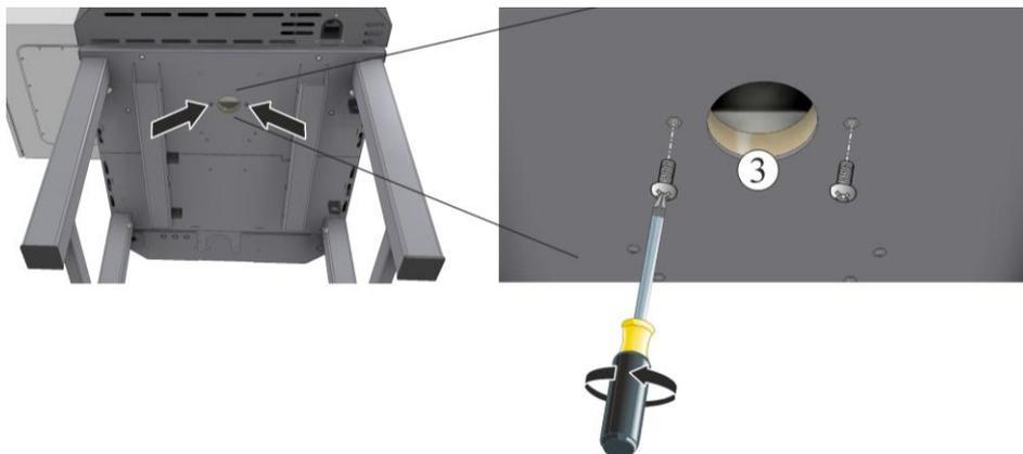
4. Placer la trappe d'entrée d'air avec les vis préalablement défaits sur la position correcte sur la sole du four, puis la fixer à l'aide d'un outil approprié. Vérifier la fermeté de la jonction (par vis) entre la trappe d'entrée d'air et la sole du four.
