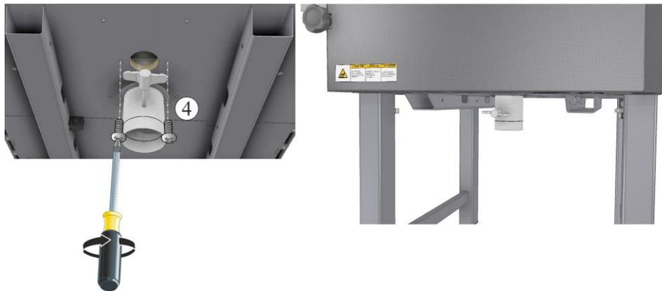
**Recommandations en matière d'évacuation d'air, pour la tuyauterie des fours N200 – N300 avec embout de bypass**
