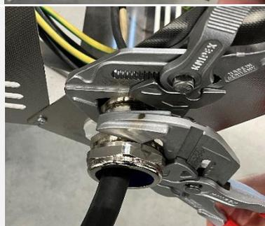
Contrôler la fermeté de la fixation en serrant tous les écrous ; resserrer le cas échéant les écrous desserrés.
