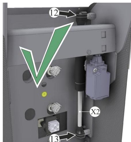
11. Avant le contrôle fonctionnel, il faut déverrouiller la sécurité du couvercle.
