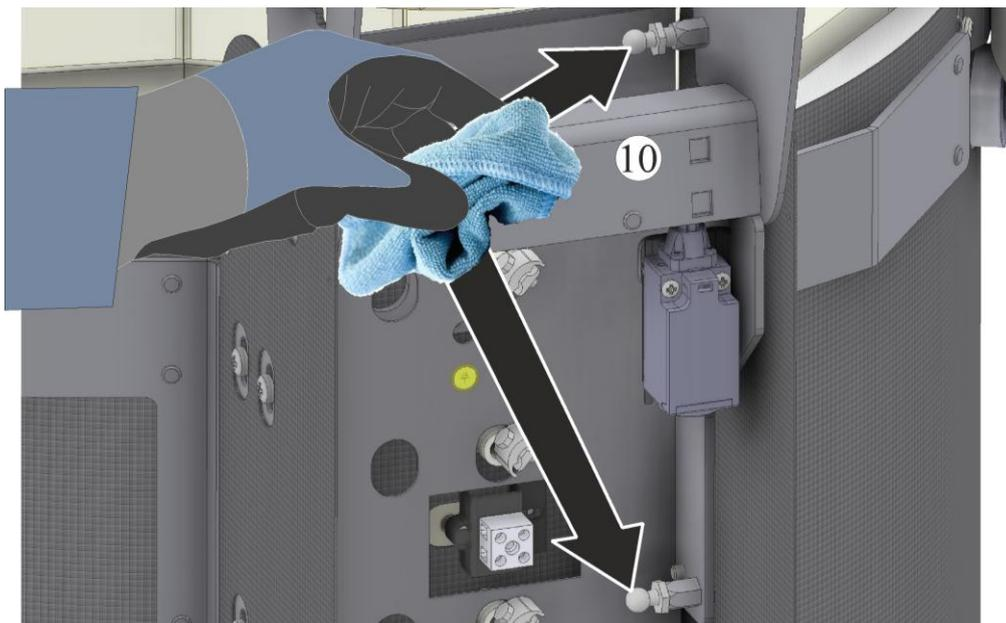
10. Montage des nouveaux ressorts pneumatiques : Le piston (X2) doit regarder vers le bas. Posez le(s) nouveau(x) ressort(s) pneumatiques sur les rotules (11) et appuyez fermement jusqu'à ce qu'ils s'enclenchent. Les agrafes de retenue sécurisent la position sur la rotule. Veillez à ce que les agrafes de retenue (12 et 13) appliquent entièrement contre la tête du boîtier du/des ressort(s) pneumatique(s).
