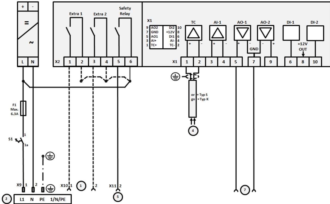
Fig. 19: Raccordement des fours de plus de 3,6 kW, zone unique
