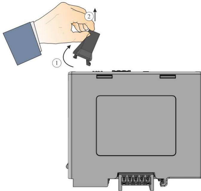
Fig. 10 : démontage du couvercle du thermocouple (figure similaire)
