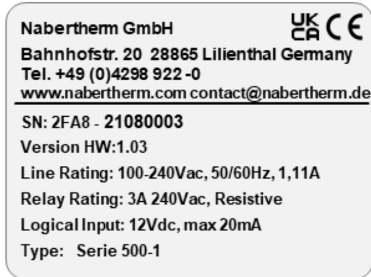
Fig. 7: exemple (plaque signalétique de l'unité de commande)
