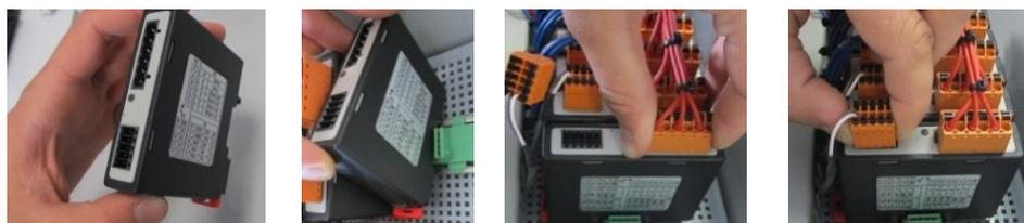
Fig. 12: Montage des modules de régulateur (figure similaire)
