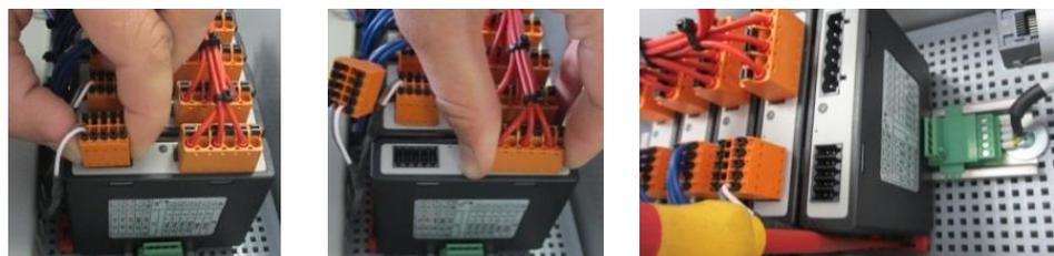
Fig. 9: Démontage des modules de régulateur - 1<sup>ère</sup> partie (figure similaire)
