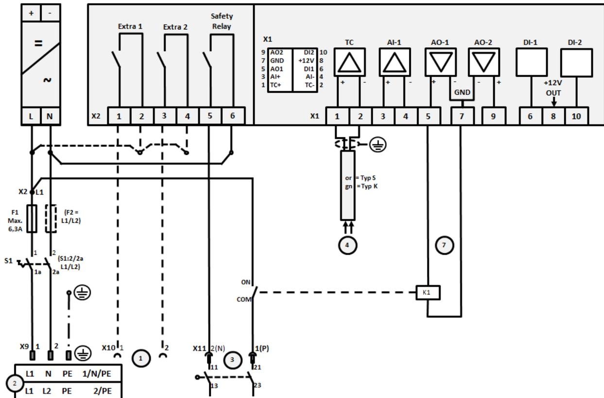
Fig. 17 : Raccordement des fours jusqu'à 3,6 kW (jusque 12.2008)
