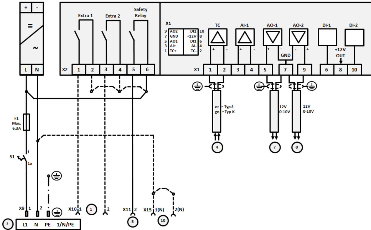
Fig. 20: Raccordement des fours de plus de 3,6 kW avec deux circuits de chauffage
