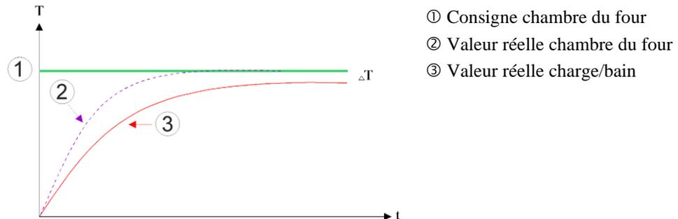
Comme nous l'avons décrit plus haut, le régulateur de charge influe sur le régulateur de la chambre du four pour compenser l'écart entre le thermocouple sur les éléments chauffants et le thermocouple sur la charge (par ex. au milieu du four). Cette compensation doit être limitée, afin que le four ne se mette pas à osciller.
