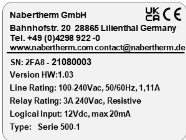
Fig. 7 Ejemplo (Placa de características de la unidad de control)
