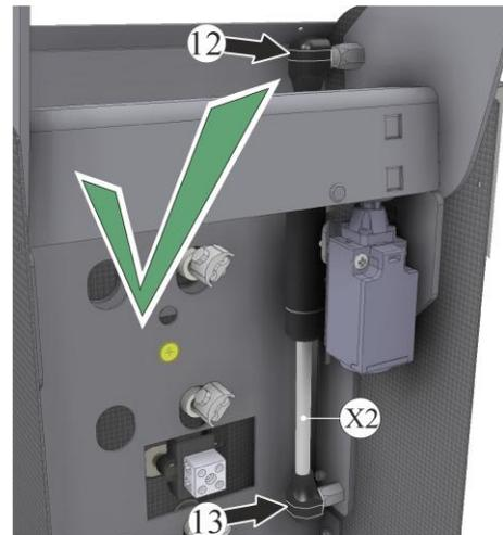
11. El seguro de la tapa debe estar desbloqueado antes de la prueba de funcionamiento.
