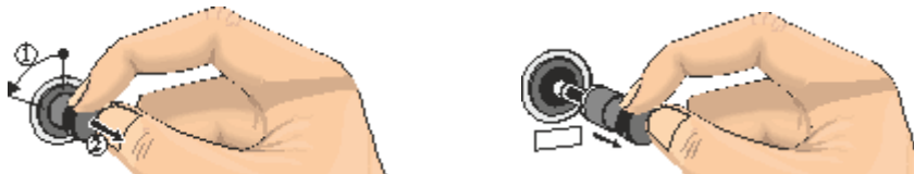
Fig. 54: Løsn sikringsholderen og træk den ud (eksempelbillede)
