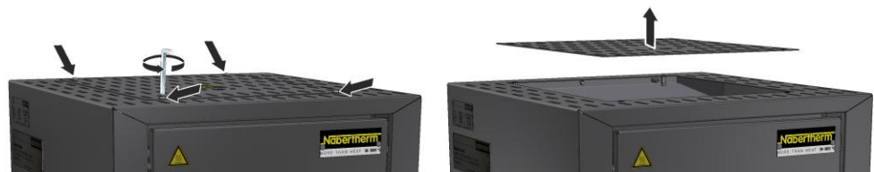
Afb. 15: Afdekking demonteren (afbeelding vergelijkbaar)
