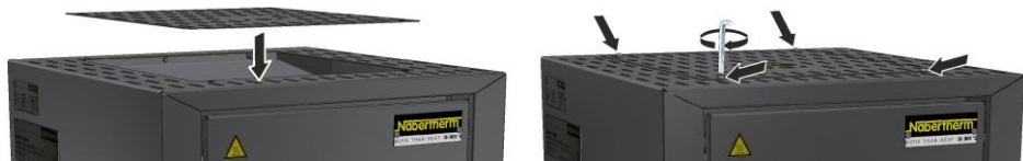
Afb. 48: Montage van de afdekking (afbeelding vergelijkbaar)
