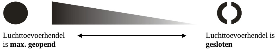
Afb. 21: Regeling van de verse lucht-toevoer
