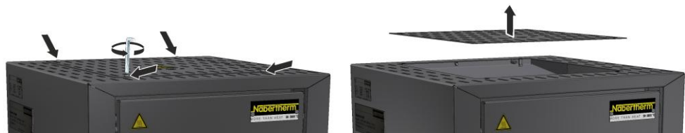
Afb. 36: Afdekking demonteren (afbeelding vergelijkbaar)
