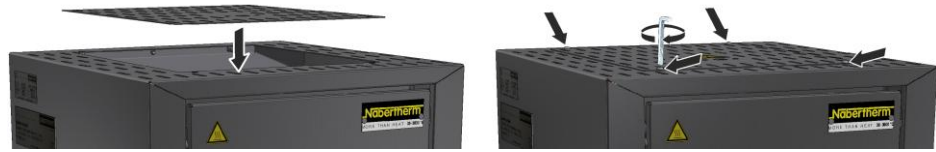
Afb. 17: Montage van de afdekking (afbeelding vergelijkbaar)
