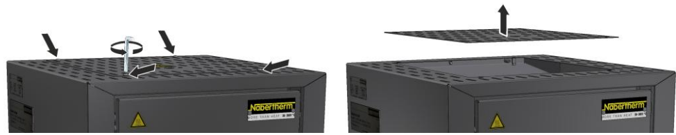
Afb. 46: Afdekking demonteren (afbeelding vergelijkbaar)
