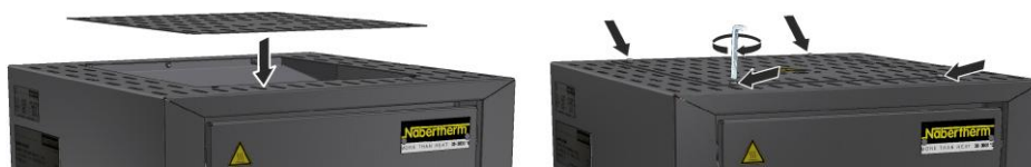
Afb. 32: Montage van de afdekking (afbeelding vergelijkbaar)
