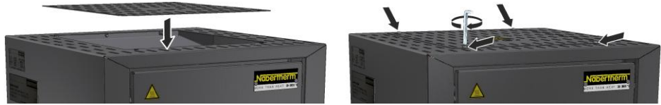
Kuva 17: Suojakatteen asennus (kuva viitteellinen)
