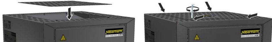
Kuva 48: Suojakatteen asennus (kuva viitteellinen)
