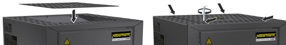
Kuva 42: Suojakatteen asennus (kuva viitteellinen)
