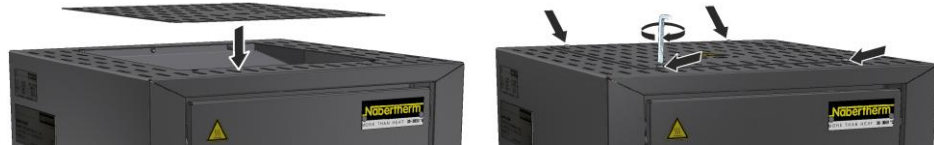
Kuva 32: Suojakatteen asennus (kuva viitteellinen)
