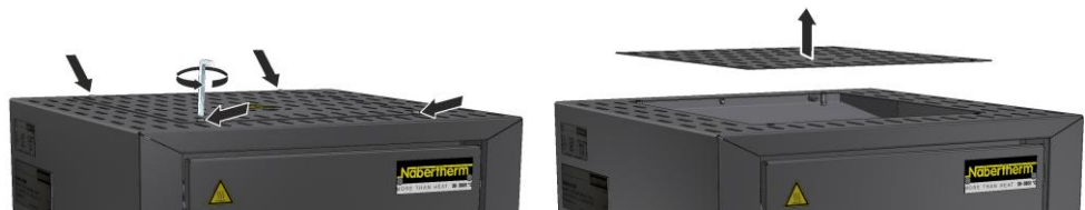
Kuva 31: Katteen purkaminen (kuva viitteellinen)
