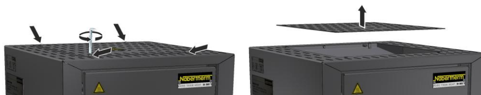
Kuva 36: Katteen purkaminen (kuva viitteellinen)
