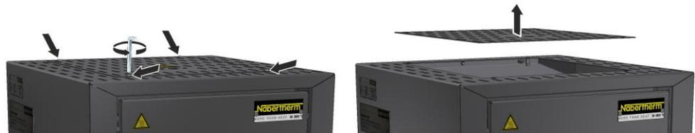
Fig. 36: Smontaggio della copertura (illustrazione simile)
