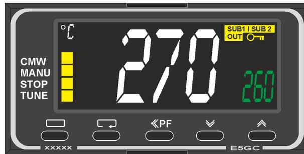
Fig. 60: Selettore-limitatore della temperatura OMRON E5GC (illustrazione simile)
