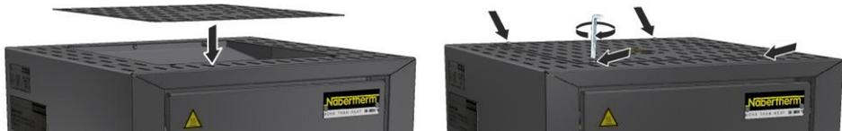
Fig. 32: Montaggio della copertura (illustrazione simile)
