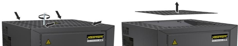
Fig. 31: Smontaggio della copertura (illustrazione simile)
