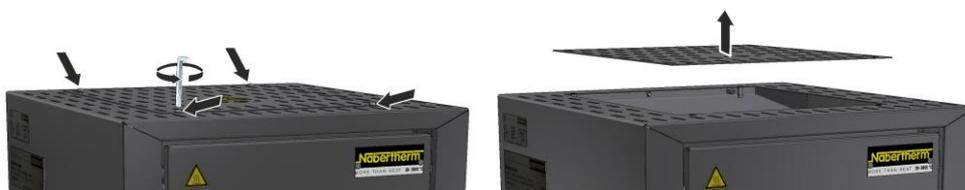
Fig. 15: Smontaggio della copertura (illustrazione simile)
