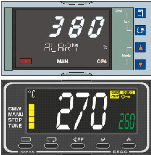
Selettore-limitatore della temperatura con temperatura di spegnimento regolabile in base alla normativa DIN EN IEC 60519-1 per proteggere il forno e i prodotti da temperature eccessive. Il modello può variare a seconda della temperatura massima del forno.
