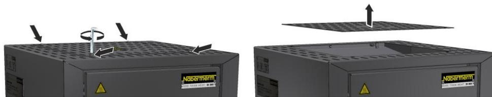
Fig. 46: Smontaggio della copertura (illustrazione simile)
