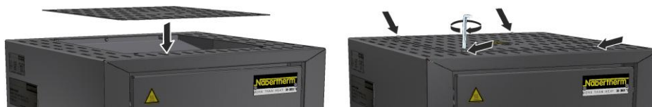
Fig. 17: Montarea capacului (similar cu figura)
