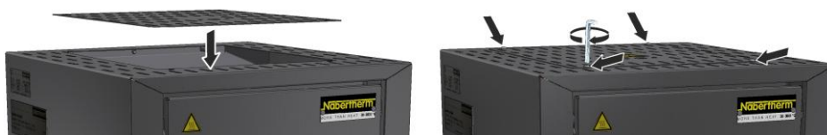
Fig. 32: Montarea capacului (similar cu figura)
