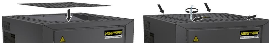
Fig. 42: Montarea capacului (similar cu figura)
