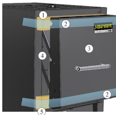
Obr. 11: Odstránenie prepravnej poistky (podobne ako na obrázku)
