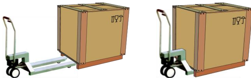
Obr. 10: Zdvíhací vozík sa kompletne zasunie pod prepravný podvozok
