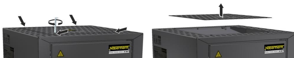
Slika 46: Demontaža pokrov (podobno kot na sliki)
