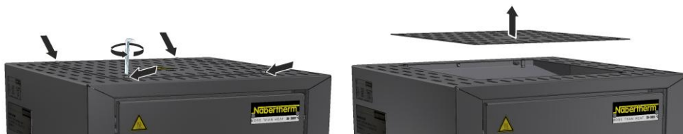
Slika 15: Demontaža pokrov (podobno kot na sliki)
