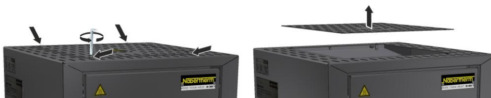
Slika 31: Demontaža pokrov (podobno kot na sliki)
